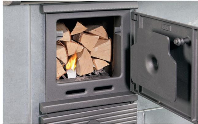
Aseta noin 2 kg pieneksi pilkottuja kuivia puita ilmavasti tulipesään (n. 10 kpl). Sytytä puut alta päin käyttäen sytytyspalaa ja laita hellan luukku kiinni.
