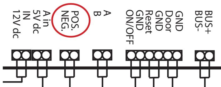
1. Koppla termoparet till bastuaggregatets styrkort.
