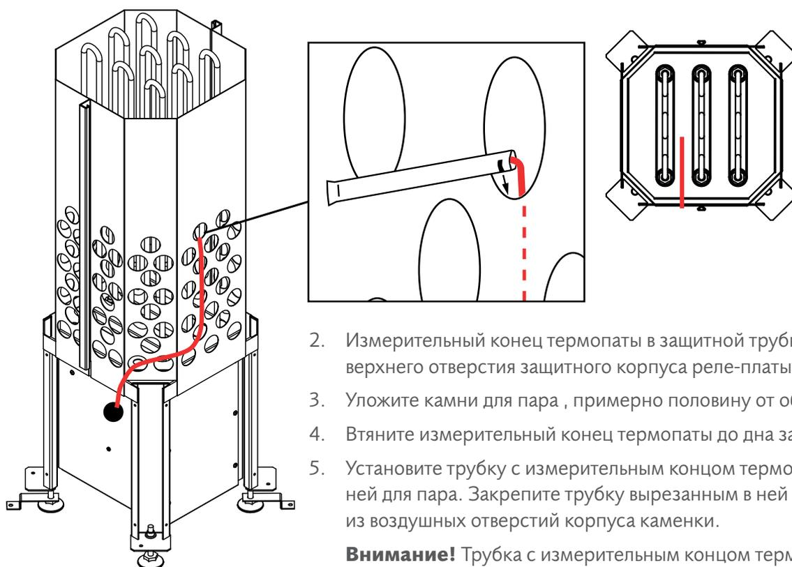
2. Измерительный конец термопаты в защитной трубке выводится из верхнего отверстия защитного корпуса реле-платы.
