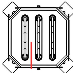
2. Pujota termopari kytkentäkotelon yläreunassa olevan läpiviennin läpi.
